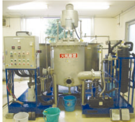
▲ 1回に処理できる量は200リットル。 5〜6時間かけて180リットルのBDF ができる。
