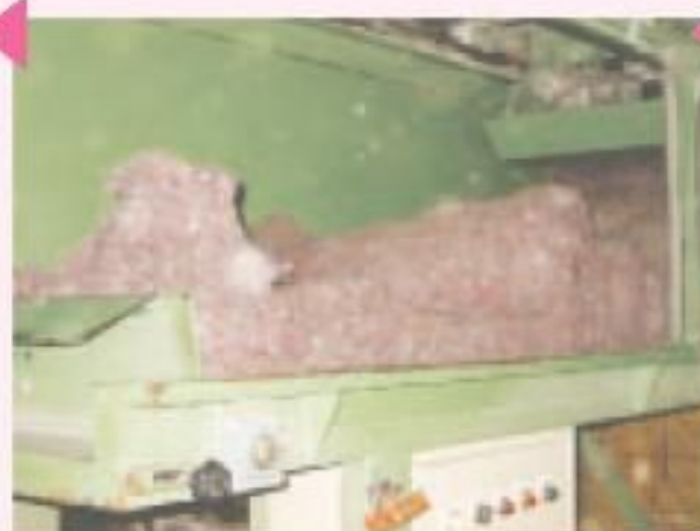
③ ②の工程を繰り返して、反毛綿にします（反毛綿）
