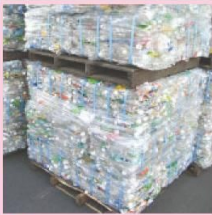
▲ ペットボトルを圧縮、梱包したバール
