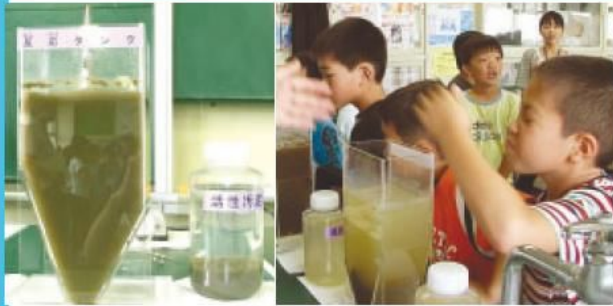
▲ 反応タンクの模型。茶色く見えるのが活性汚泥。
