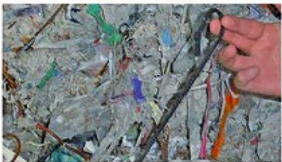
▲溶けた古紙の中から取り出したビニールひもなどの異物。
