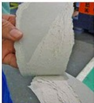
▲板紙を裂くと何枚もの紙の層が見える。
