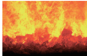
写真5：燃焼中の焼却炉。炉内の温度は850～950℃で、ごみは自然発火して燃える。
