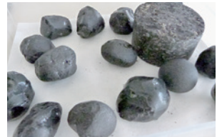
写真7：焼却灰を原料に灰溶融施設でつくられた溶融スラグ。路盤材に使われる。
