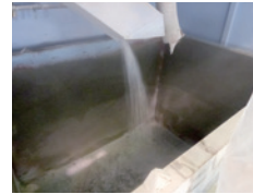
洗浄後のガラスカレット回収口。
