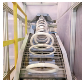
処理機の中に丸管が入っていく様子。
