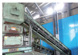
右の青い機械が破碎機。 左の緑の機械が磁気選別機。
