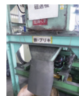
磁気選別機の 鉄回収口。
