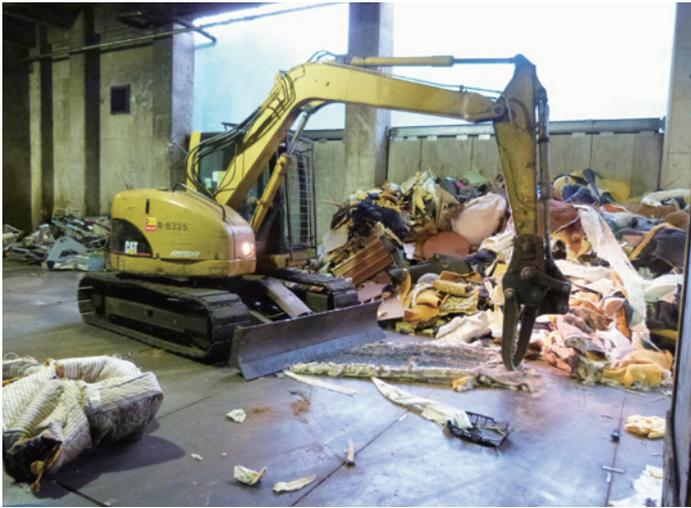
写真6: 重機を使ってマットレスの外被を剥がす。
