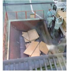
写真11: 破砕機に畳を投入。中のカッターで切断していく。
