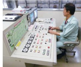
写真12: 破砕機の操作台。モニターを見ながら運転する。
