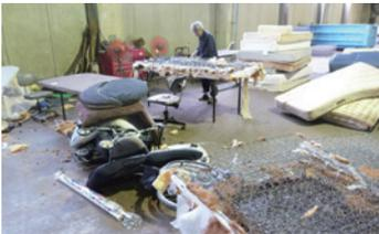
写真7: スプリング内部のクッション類は手作業で外す。
