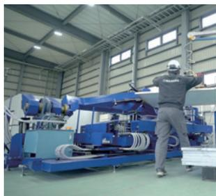
専用装置にセットして、電材部品とパネルを分離
