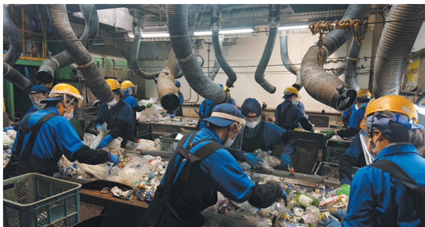
コンベヤーを流れる大量の「缶・びん・ペットボトル」から異物を取り除き、素早く的確な選別作業を行う。
