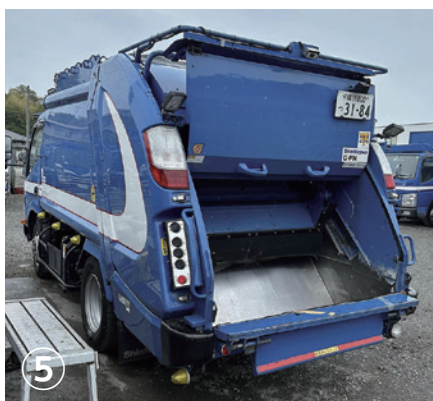
写真⑤ 後部左側にある圧縮板の操作パネルの一番下の赤いボタンが緊急停止ボタン。右側にも設置されています。
