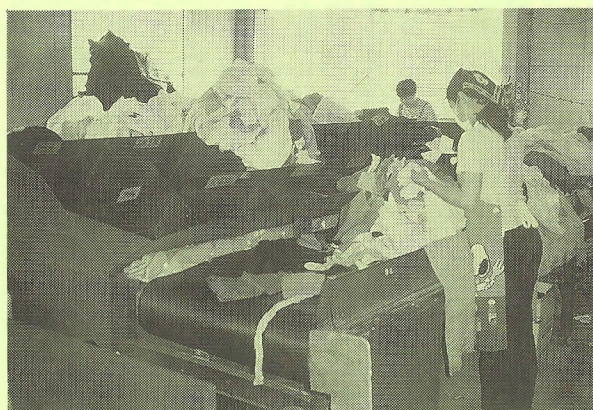
衣類はかさばるので圧縮して輸出しています。深さ二メートルの穴いっぱいに入れた衣類を圧縮すると、こんなに小さくなってしまう。こうした機械の多くは工場長が工夫して作ってもらったもの
